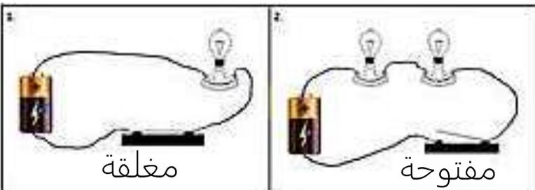
عندما يغلق المفتاح يكون في وضع التشغيل الدائرة الكهربائية تكون مغلقة فيمر التيار و يضيء المصباح
